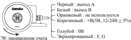
\* Неиспользуемые провода должны быть изолированы.
